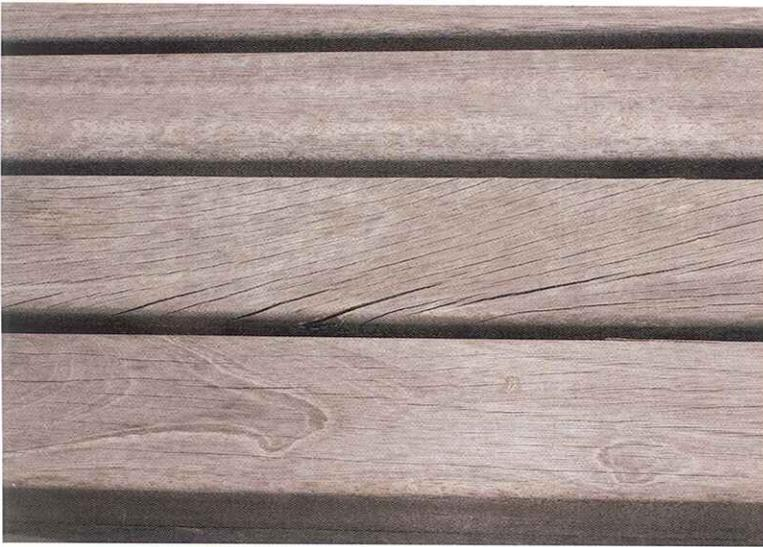
Drehwuchs ist ein um die Stammachse spiralförmig laufender Faserverlauf, der bei frischem Holz schwer zu erkennen ist. Erst mit der Trocknung und damit einhergehender Rissbildung wird der schräge Faserverlauf sichtbar.
