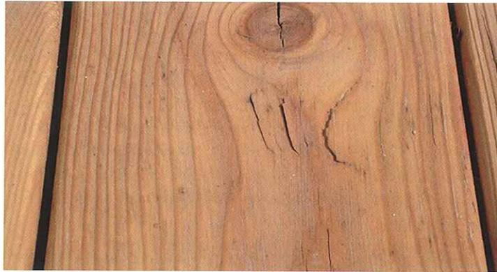
Schilfer/Ablösung der Jahrringe bei Nadelhölzern; darüber trocknungsbedingter Riss im gesunden Ast
