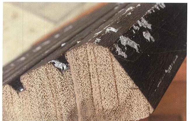
Harzaustritt: Entlang von Harzkanälen (dunkelbraune Linien auf Hirnholz) kann Harz austreten, das nach dem Abtrocknen weiß auskristallisiert. Mit harzlöslichen Mitteln wie Aceton, Spiritus etc. lassen sich flüssiges Harz und Harzkrusten leicht entfernen.
