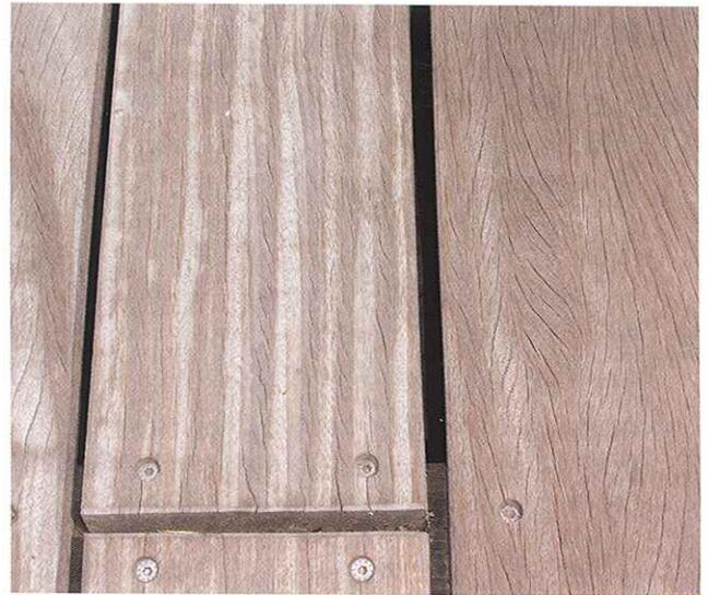
Wechseldrehwuchs ist charakteristisch für viele Tropenhölzer. Der wechselnde Faserverlauf ist je nach Einschnitttrichtung an den spiegelnden Streifen (linkes Brett) zu erkennen, bzw. wird in Form keilförmig zulaufender Risse sichtbar (rechtes Brett).
