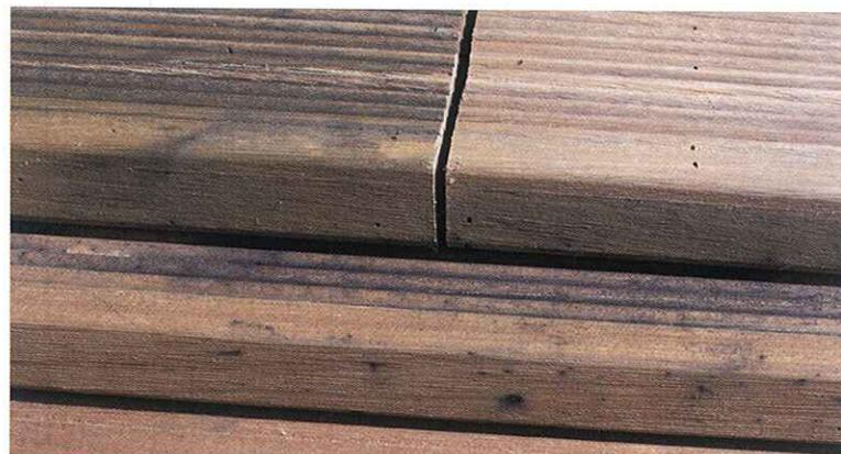
Schwarze Verfärbungen durch Eisengerbstoffreaktion bei Bangkirai. Die obere rechte Bretthälfte ist mit unverdünntem fachhandelsüblichen Holzentgrauer behandelt.
