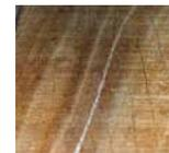
Durch eine rasche Trocknung, z.B. durch Wärme oder Sonneneinstrahlung, können kleine Risse entstehen. Eine niedrige Luftfeuchtigkeit verstärkt diese Rissbildung. Diese Trocknungsrisse sind ganz natürlich und leider nicht vollständig vermeidbar. Sollte eine Diele allerdings durchgerissen sein, deutet dies auf eine Schwachstelle oder einen mechanischen Schaden. Derartige Risse sind unzulässig.
