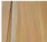
Splintholz ist das äußere Holz unter der Rinde des Stammes. Dieses Holz hat noch nicht die gleiche Haltbarkeit und Festigkeit wie der Rest des Stammes und ist daher anfälliger für z.B. Schimmelbefall. FCQ bemüht sich um splintfreies Holz. Betroffenes Splintholz darf in gehobelten Dielen nicht vorkommen. Zugelassen ist lediglich ein Splintteil bis zu 1/3 der Dielenbreite und einer Länge von 30 cm.
