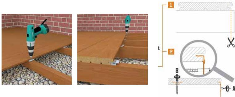
**1.** Den B-Fix Border auf die Schnittfläche des Unterbalkens setzen. Die kleine Hemmkante muss auf der Oberfläche der Schwelle aufliegen. Mit einem Torx 20 Aufsatz im oberen Loch des B-Fix Borders fest dagegen schrauben. Danach den Unterbalken mit einer Richtschnur ausrichten.
