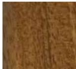
Hartholz verdankt seine Haltbarkeit u.a. auch spezifischen Inhaltsstoffen. Allerdings können z.B. durch starken Regen überschüssige Inhaltsstoffe ausgespült werden (ausbluten) und auf umliegenden Teilen nur schwer zu entfernende Flecken hinterlassen. In der ersten Zeit empfiehlt es sich daher, diese zu schützen. Bei nicht-porösen Materialien lassen sich diese Flecken größtenteils vorsichtig mit einer Chlorlösung entfernen.
