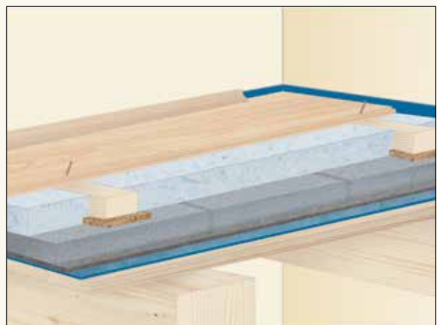
Verlegung auf Lagerhölzern über Holzbalkendecke. Anwendungsbereich: Neubau .
