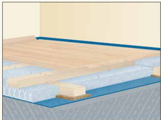
Verlegung auf Kreuzlattung über Betondecke. Starke Reduzierung des Trittschalls. Erleichtert den Ausgleich von Unebenheiten des Untergrundes durch einfaches Unterfüttern an den Kreuzpunkten.
