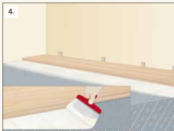
4. Wenn die ersten Reihen schubfest verklebt sind, weiter verlegen, nicht zu große Flächen Kleber aufzählen, die Nut-Feder-Verbindung wenn nötig mit Schlagklotz schließen und die Dielen ins Kleberbett drücken.
