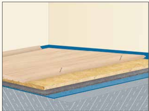
Verlegung auf OSB-Platten über Betondecke.
