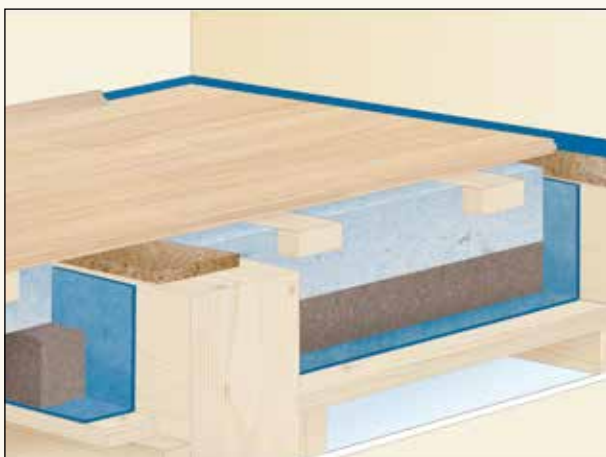
Verlegung mit Lagerhölzern über Holzbalkendecke. Anwendungsbereich: Altbau .
