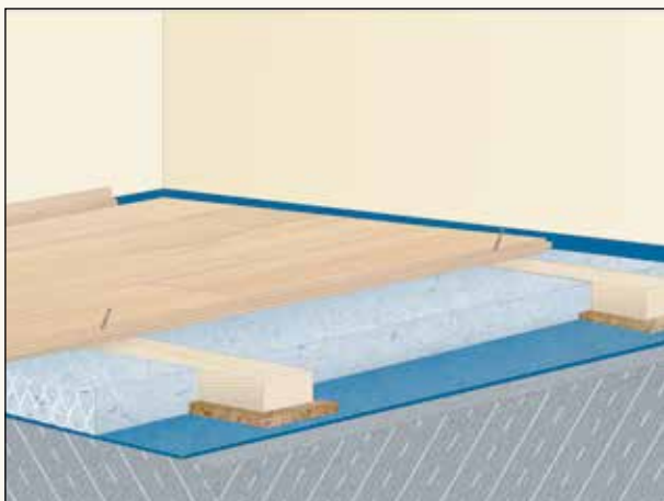
Verlegung auf Lagerhölzern über Betondecke. Preisgünstiger Standardaufbau.
