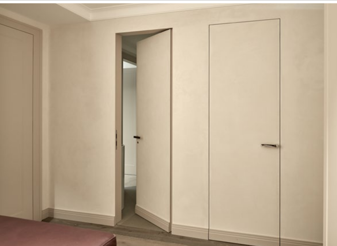
Türblatt Typ G | Ausführung als Tapetentür | mit durchlaufender Fußleiste
